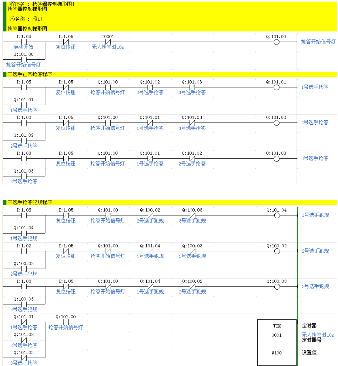
图 3.3 三人抢答器控制梯形图
