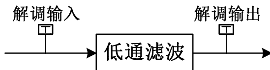
图 抽样信号的还原原理框图
