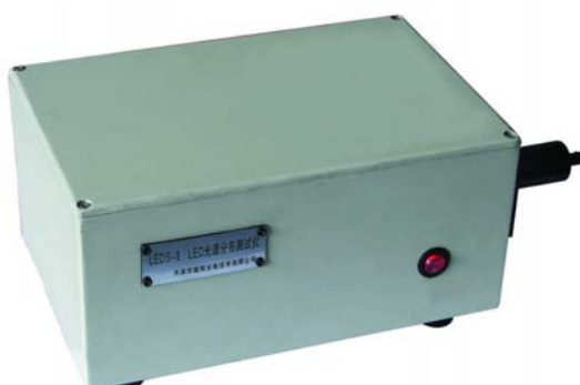
图 1.2-1 LED 光谱分布测试仪
