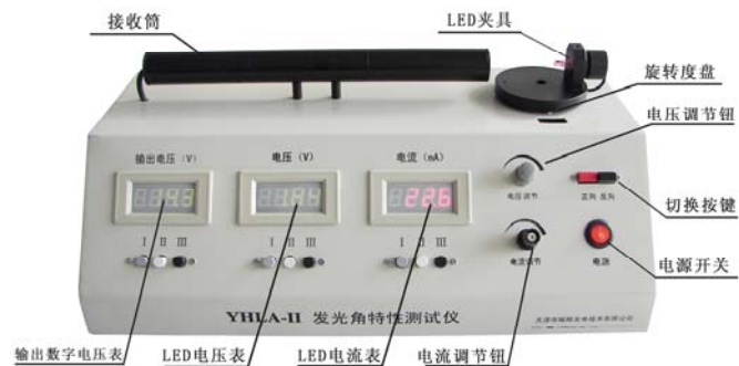
图 1.3-2 LED 发光角度特性测试仪结构图
